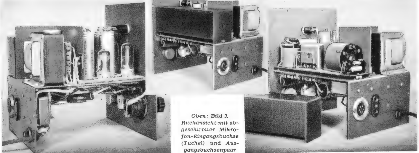
Unten: Bild 2. Seitenansicht des Clipper-Filters mit Netzteil
